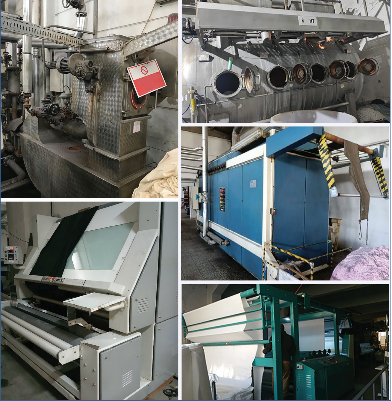
Resim 3. 2000 Yılı Öncesinde Üretilmiş Çeşitli Yerli Tekstil Makinaları (EMS overflow boya makinası, Vega boya makinası, Güven Çelik kumaş kontrol masası, Mersan fikse makinası ve Memnun zımpara makinası)
